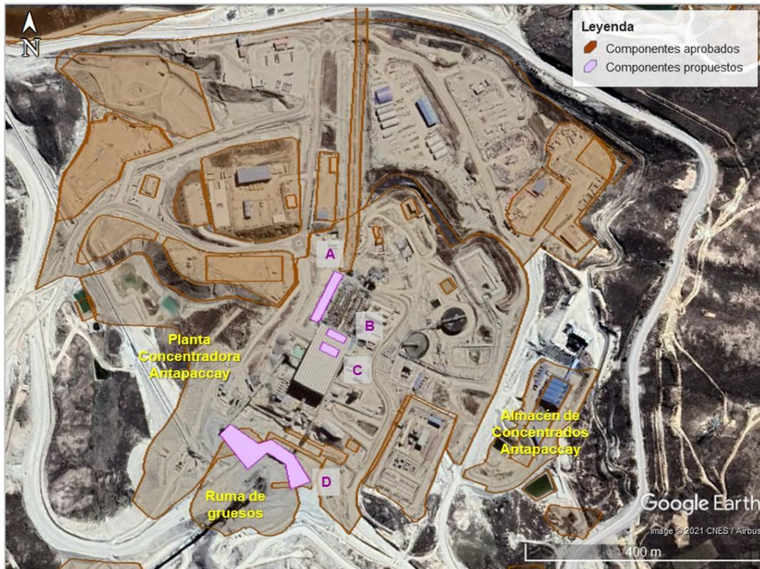
A: Instalación de tres celdas Scavenger en la Línea 3 de Flotación / B: Implementación de sistema de muestreo de pulpas de cabezas de Antapaccay / C: Modificación del funcionamiento del tercer nido de ciclones / D: Modificación del funcionamiento de chancadoras móviles y adición de faja transportadora
