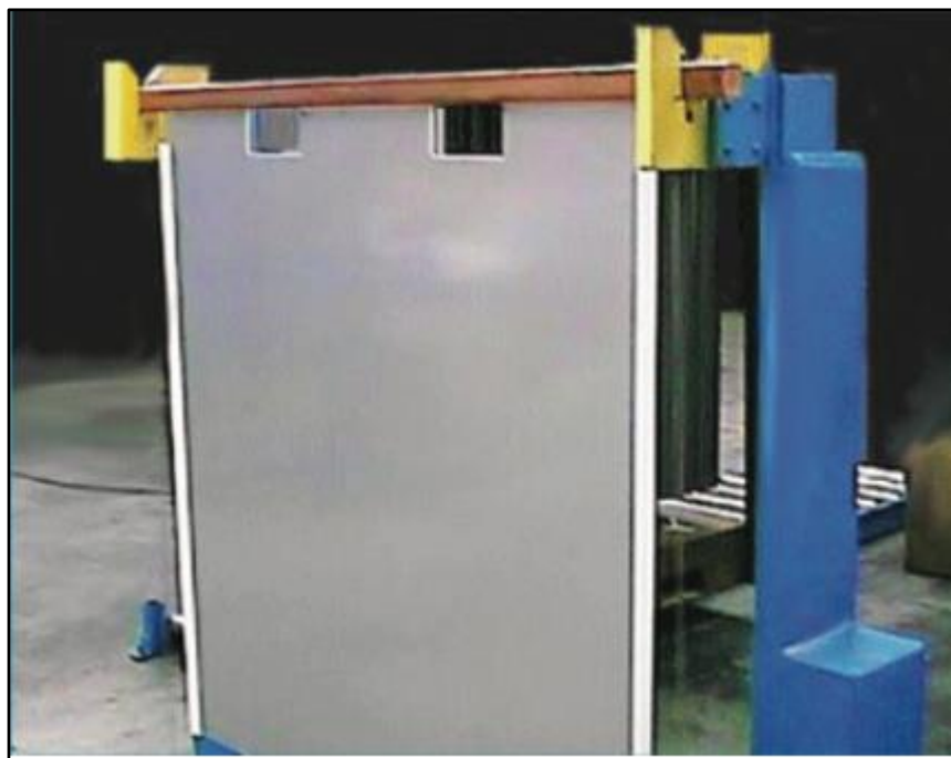
Figura 9.3.2.1- 5 componentes Cátodos permanente inoxidable Tipo Kidd Process
